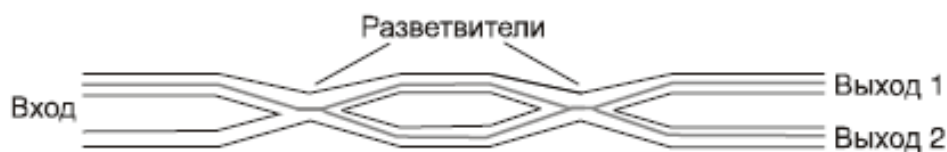
Рис. 4. Входной сигнал распределяется между двумя выходами
