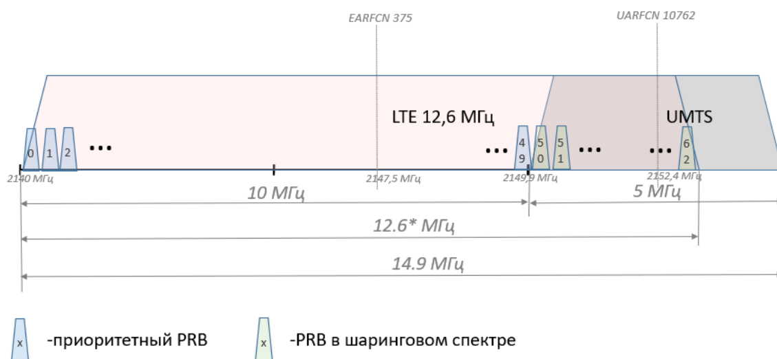
Рис. 3 Реализация DSS в полосе частот 2100 UMTS+LTE
