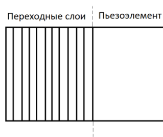
Рис. 3. Схематическое изображение ультразвукового преобразователя с несколькими переходными слоями
