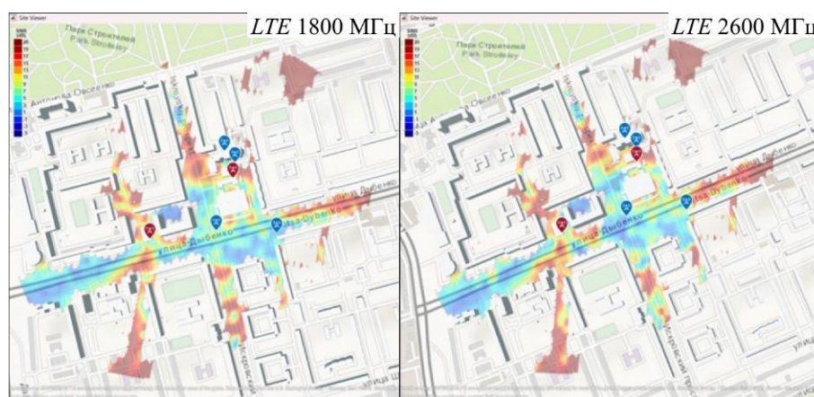
Рис. 4. Тепловые карты SINR LTE 1800 МГц и LTE 2600 МГц
