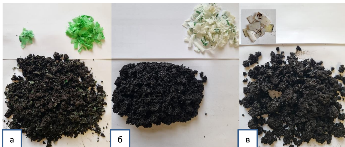
Рис. 1. Образцы почвы с различными полимерными отходами (а – кусочки пакета Polymeteria; б – кукурузный пакет; в – кусочки ПВХ)
