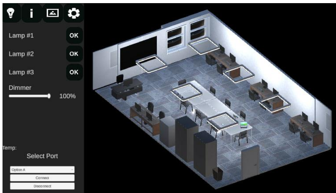
Рис. 2. Пример интерфейса виртуальной модели цифрового двойника учебной лаборатории
